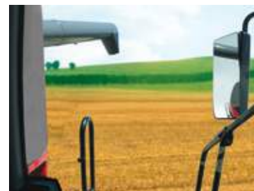
Přímý výhled na vyprazdňovací šnekový dopravník v činnosti
