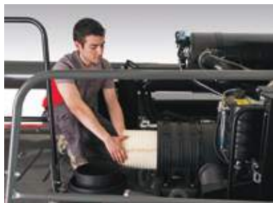
Kontrola a čištění filtru vzduchu
