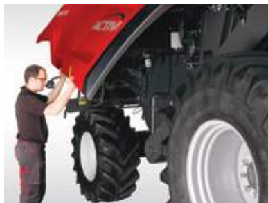
Jednodílné panely s osvětlením umožňují rychlý přístup při kontrole
