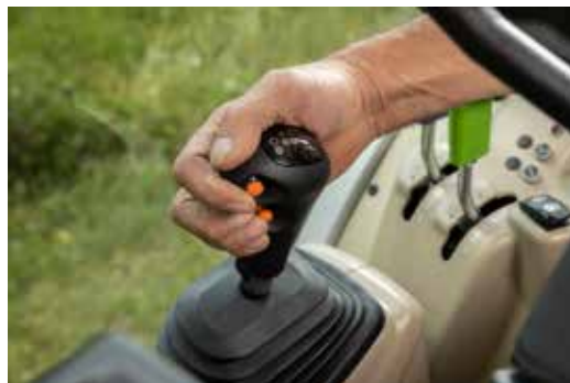
▲ Nová řadicí páka s bovdenovým lankem pro plynulou obsluhu.
