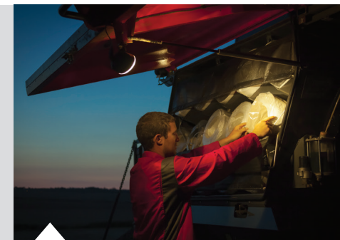
Zásobník motouzu s osvětlením usnadňuje výměnu motouzu i v noci.
