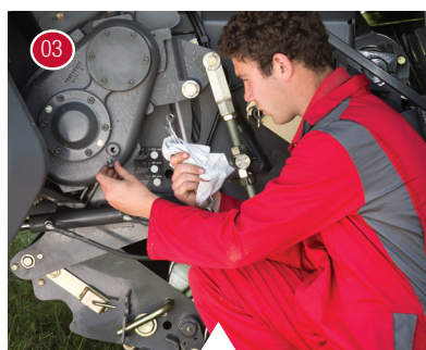
03 Kontrola hladiny oleje v převodovce řezačky.
