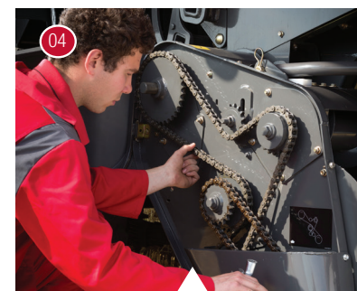
04 Kontrola napnutí řetězů pro sběrací ústrojí
