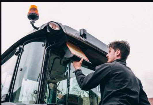
Snadný přístup k demontáži vzduchového filtru v kabině pro snadné čištění.
